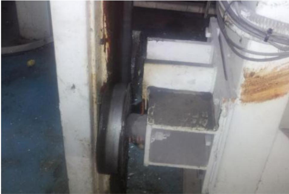
**Figure 2.20 : Graissage des galets pour éviter les frottements:**
