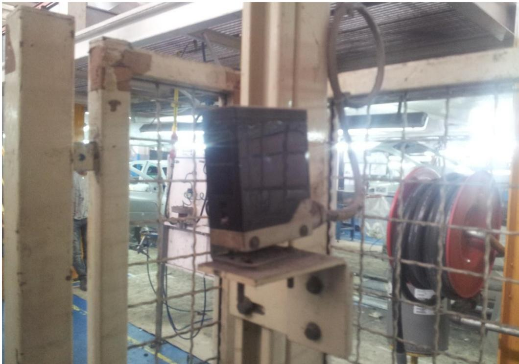
**Figure 3.5 : Emetteur photocellule de présence :**
