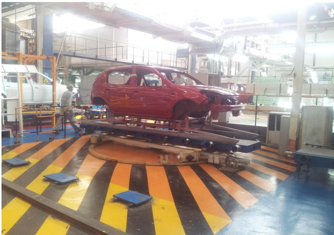
**Figure 2.8 : table pivotante dans la zone finition :**
