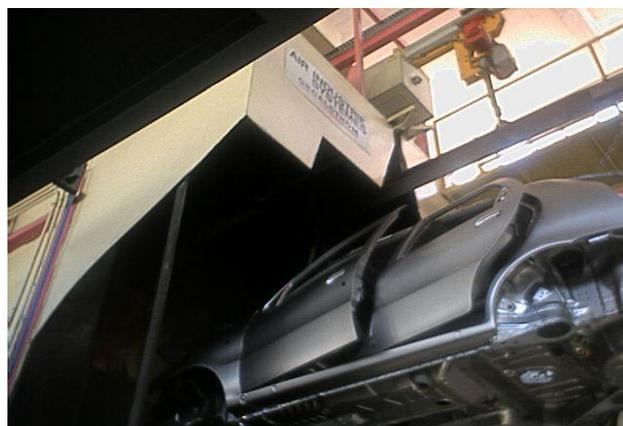
**Figure 1.8 : caisse allant vers le bain de traitement de surface :**
