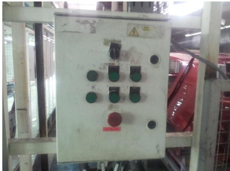
**Figure 2.11 : pupitre de commande de l'élévateur :**
