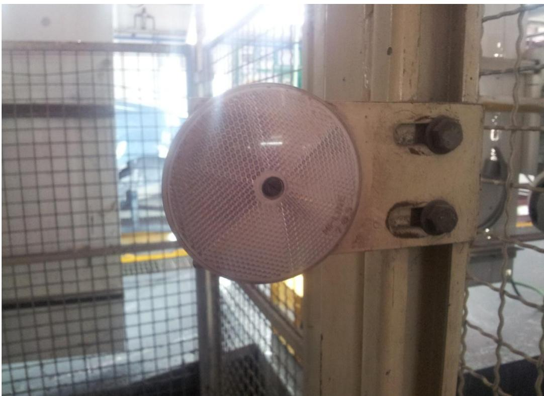
**Figure 3.6 : Récepteur photocellule de présence :**
