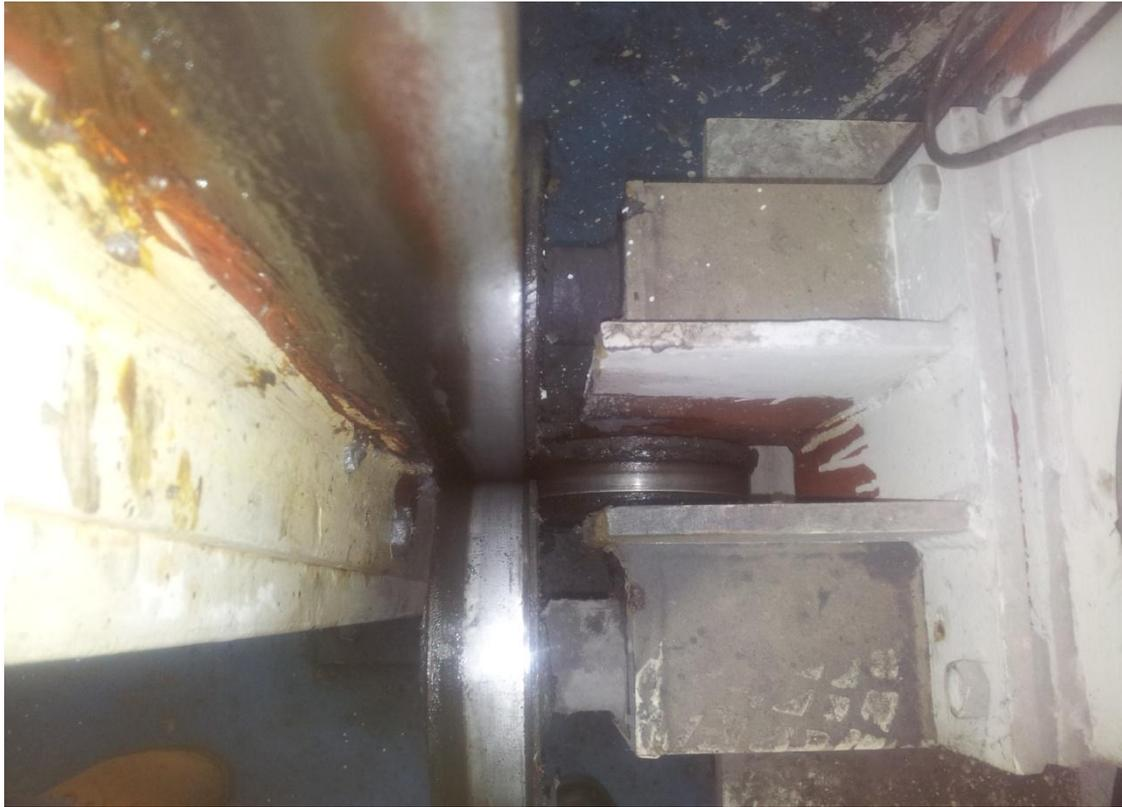
**Figure 2.18 : Usure des galets de guidage en translation :**
