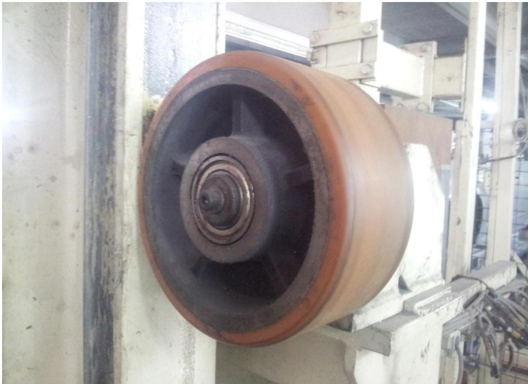
**Figure 2.21 : Etat normal des galets de guidage:**
