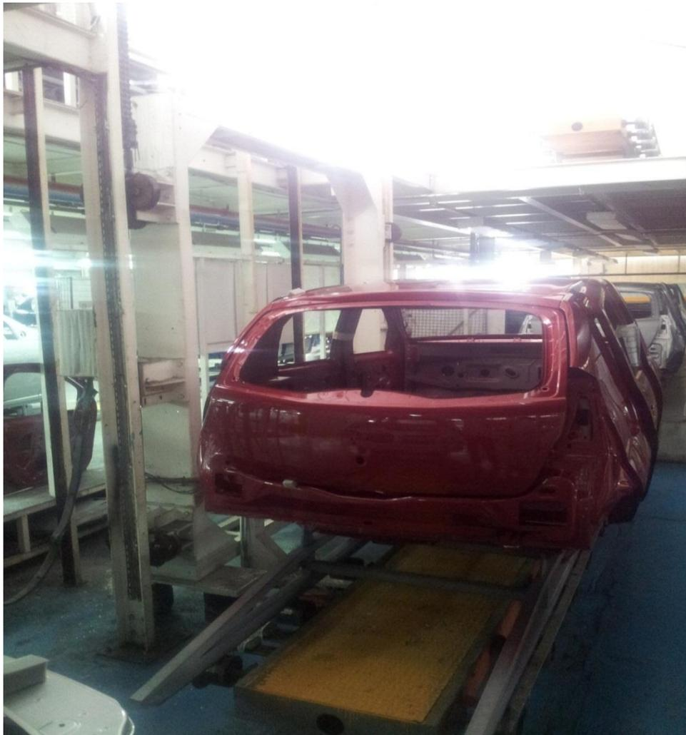
**Figure 2.3 : Photo de l'élévateur en position basse :**
