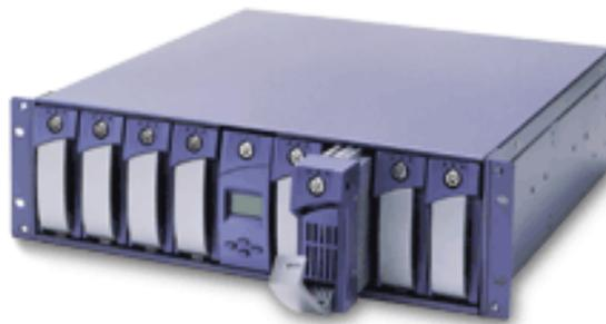
L'ensemble est censé encaisser la panne d'au moins un disque dur. En cas de panne d'un disque dur, le système continue de travailler. Un disque en remplacement sera rempli par des données reconstruites à partir des données sur le reste des disques de l'ensemble.
