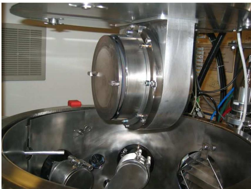
Figure III.4 : Photographie de l'ensemble porte substrat : en premier plan, on observe le porte-substrat chauffant accolé au porte substrat refroidi que l'on nomme porte-substrat « chaud » (PSC) et porte-substrat « froid » (PSF).
