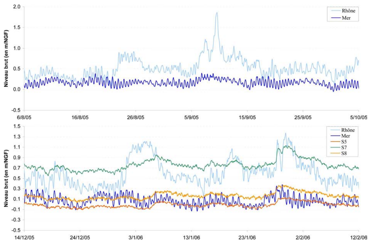
Fig. 60. Influence de la mer sur les variations du niveau du Rhône et de l'aquifère captif
