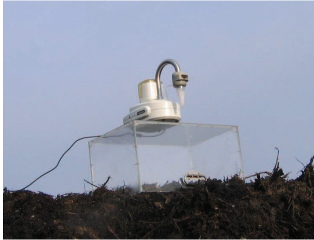
Figure 18 : Photo du biocollecteur d'air Coriolis ® \mu (Bertin Technologies, Montigny-le-Bretonneux, France).
