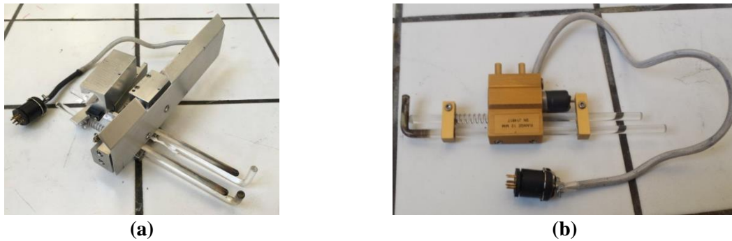
Figure III-3 : (a) Extensomètre LVDT modèle 39060 et (b) C Gauge
