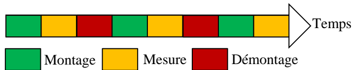
Figure 2.30. Procédure d'essais pour vérifier la répétabilité des mesures vibratoires.
