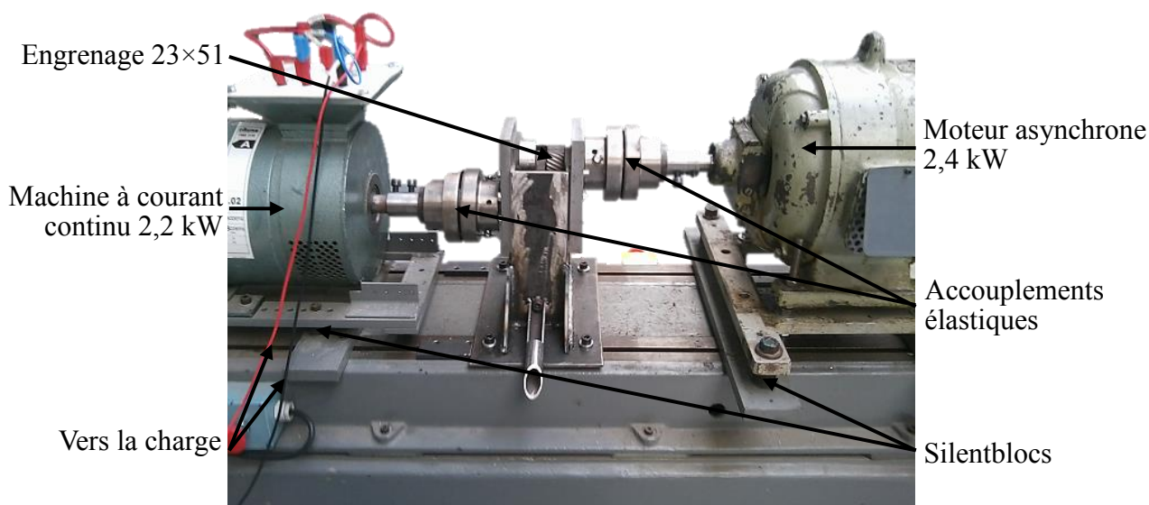
Figure 2.25. Banc d'essai instrumenté de faible puissance pour mesurer les vibrations d'un engrenage simple étage développé au laboratoire MSMP.
