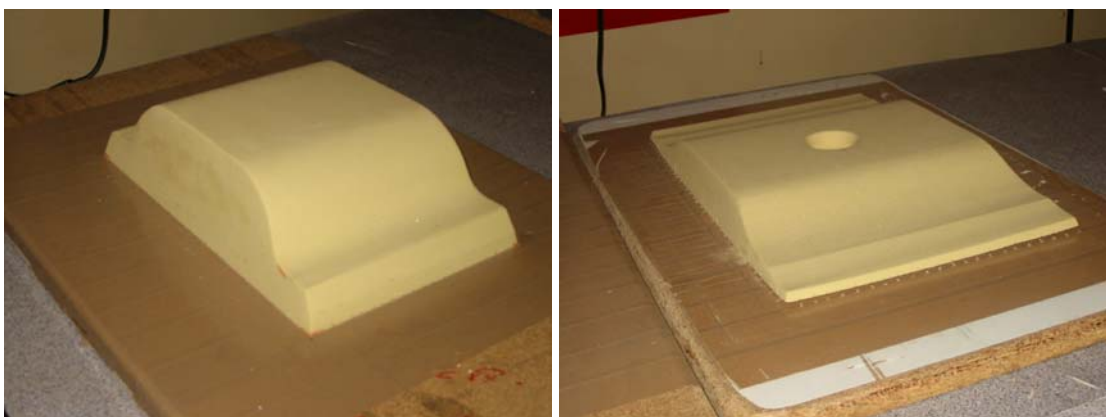
Figure 12. Moules en mousse pour thermoformage.
