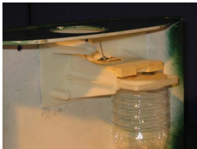
Système de raccordement de la cartouche : raccord pivotant et glissière
