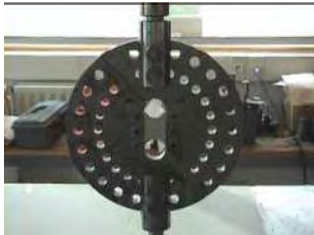
Fig. V-75 Montage expérimental des essais Arcan [19].
