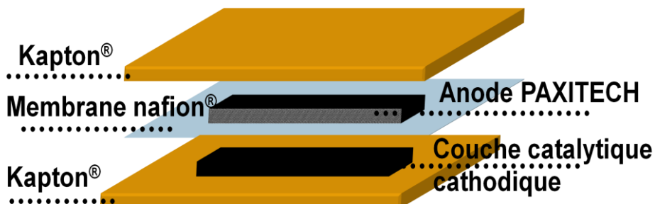
Figure 30: Assemblage pour la première étape de pressage
