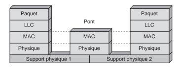
Le pont enregistre dans des tables internes les adresses de toutes les stations connectées au réseau. Si une station est ajoutée ou enlevée, le système doit être reconfiguré. C'est la raison pour laquelle les ponts ne peuvent *a priori* être utilisés que dans des environnements bien localisés. Dès que le nombre de stations est important, la gestion des adresses devient très complexe.
