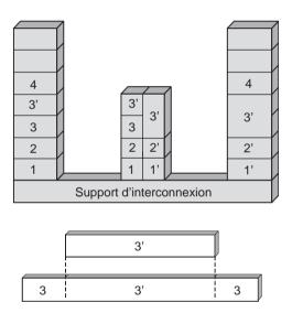
La même solution s'offre au concepteur de réseau pour interconnecter des machines IPv4 par l'intermédiaire d'un réseau IPv6. Il suffit d'encapsuler le paquet IPv4 dans le paquet IPv6 puis, à l'arrivée, de décapsuler le paquet IPv6 pour retrouver le paquet IPv4.
