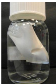
Figure 3-16 Coagulum de latex de NR obtenu par dialyse de latex de NR 20% en masse contre une solution de Mg^{2+} à 50mM
