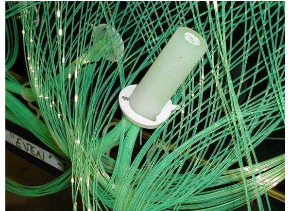
FIG. 3.21 – Groupement de fibres optiques, avant placement en amont d'un photomultiplicateur [54]
