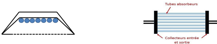
Figure 2-19: Schématisation simplifiée d'une ligne de récepteur Fresnel : vue en coupe (gauche) et vue partielle de haut (droite)
