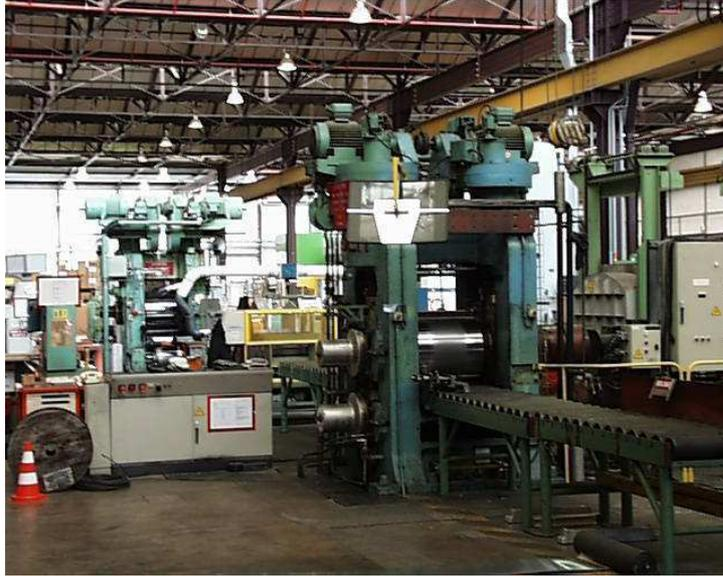
FIG. 1.3: Photographie du laminoir pilote de CRV ALCAN sur lequel les tôles AA5182 sont mises en forme.
