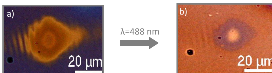
Figure 3.9 : Motif non effaçable photo-inscrit à 244 nm avec une intensité de 43 kW cm -2 avant (a) et après insolation à 488 nm (b).
