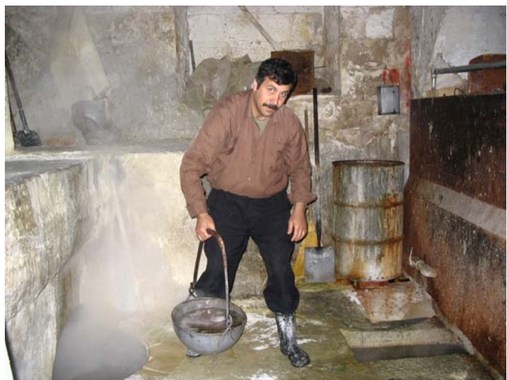
Photo 31. Samîr enlève de l'eau concentrée de la cuve et rajoute de l'eau claire
