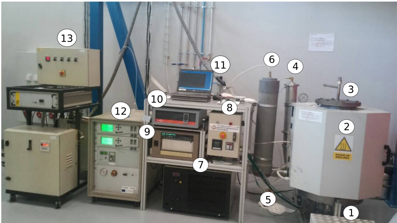
FIGURE 3.2 – Photographie du dispositif expérimental doté de : 1) préchauffeur, 2) four, 3) réacteur, 4) condenseur, 5) thermocouples, 6) filtre à charbon actif, 7) cryostat, 8) régulateur des résistances du préchauffeur, 9) système d'acquisition, 10) régulateur des résistances latérales du four, 11) enregistreur de données (MolyView), 12) analyseur de gaz, 13) commande pompe de prélèvement de gaz
