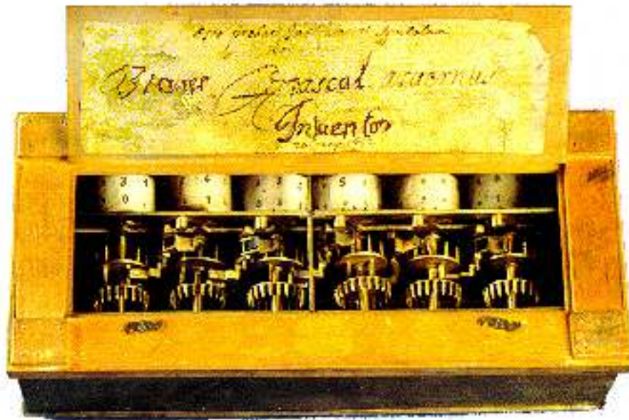
Planche 4.1 – Machine à additionner de Pascal
