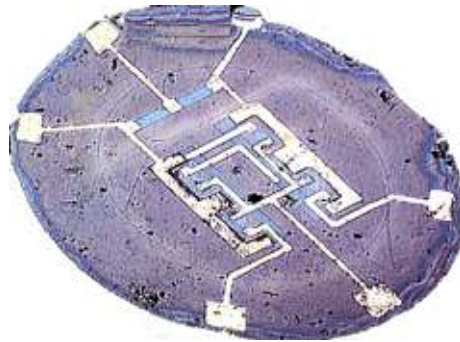
Planche 15 – Premier circuit intégré planaire, 1960
