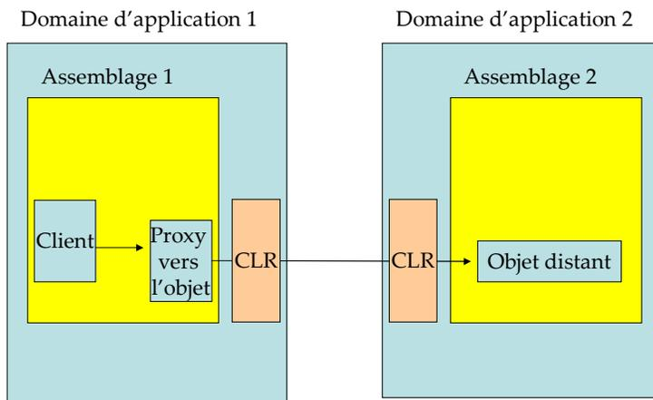
Faire dériver une classe à partir de *MarshalByRefObject()* indique au compilateur JIT qu'une instance de cette classe peut être utilisée d'une manière distante grâce à un proxy transparent.
