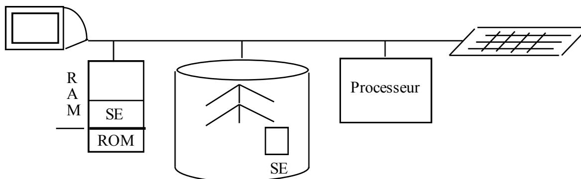
Rappelons que quand l'ordinateur démarre, le petit programme codé dans la ROM va chercher le logiciel « système d'exploitation » (XP, LINUX, UNIX, MacOS, etc... SE sur le schéma) sur le disque dur et le recopie sur la RAM. L'utilisateur communique alors avec le système d'exploitation. Le système d'exploitation offre trois grands types de fonctionnalité : la gestion des fichiers (dir, cd, grep, etc.), la gestion des périphériques et le lancement des logiciels.
