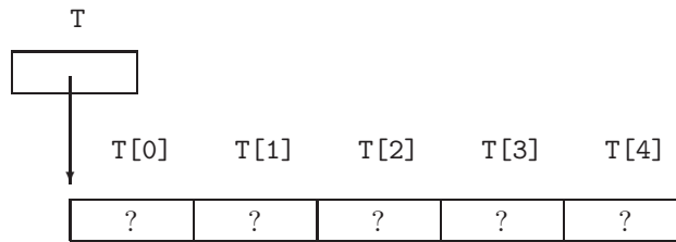
FIGURE 4.1 – Création d'un tableau d'entiers à 5 éléments
