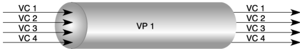
Figure 17. Multiplexage de VC dans un VP.
