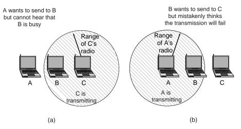
Contrairement au cas précédent, il n'est pas possible de détecter toutes les collisions à l'émetteur. De plus, l'émission est en général incompatible avec la réception, c'est-à-dire qu'il n'est pas possible de détecter les collisions.
