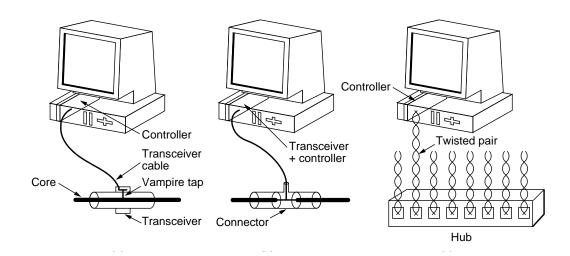
Dans un LAN utilisant les signaux électriques sur paire torsadée, les interfaces se partage un même circuit électrique *en parallèle*.
