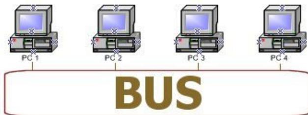
Les câbles utilisés sont souvent de type COAXIAL. On retrouve la topologie en BUS sur des réseaux Ethernet 10 base 2, Ethernet 10 base 5, CATV.
