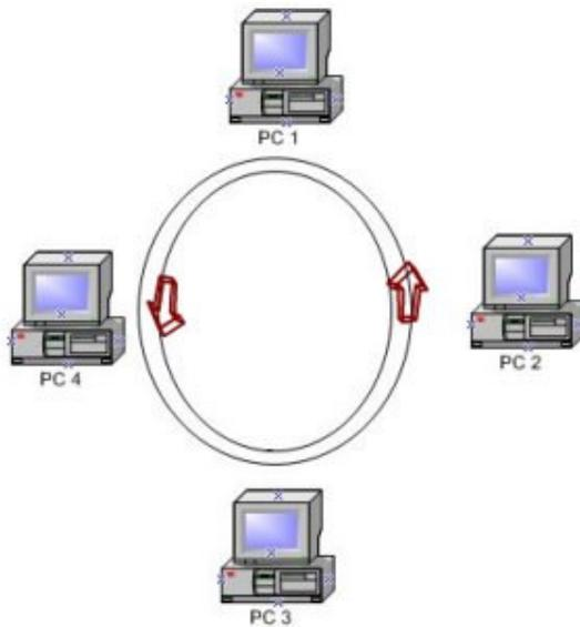
Les stations du réseau ne peuvent communiquer seulement quand elle possèdent le jeton. Le jeton est intercepté par la station qui souhaite émettre ou recevoir des trames. Une seule station peut donc "causer" dans le même laps de temps. En FDDI, il y a une deuxième boucle de secours au cas où la première boucle est temporairement inutilisable.
