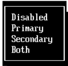
**SMART Device Monitoring** : active ou non la technologie Self Monitoring Analysis and Reporting Technologie pour la gestion des disques durs (Prediction Failure).
