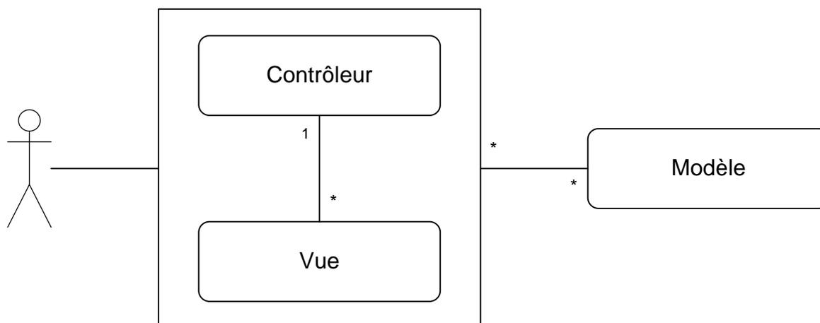
L'utilisateur ne voit qu'une vue, qui fait appel à un contrôleur (lui-même pouvant être utilisée par plusieurs vues), lui-même faisant appel au modèle pour réaliser des traitements de données. Le résultat de ces traitements sera récupéré par la vue qui les affichera.
