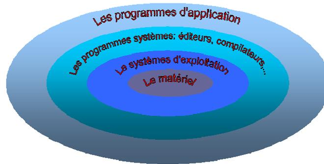
Le système d'exploitation (operating system en anglais) est la partie la plus importante et la plus connue de ces programmes systèmes voire d'un système informatique tout court. En effet, il est beaucoup plus courant de dire que l'on travaille sur tel ou tel système (UNIX, LINUX, MS-DOS, Windows, OS2, ...) plutôt que sur telle ou telle machine.
