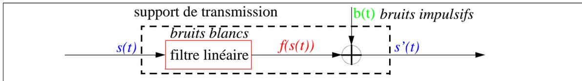
La **bande passante** d'un support de communication correspond à la plage de fréquences où il présente les meilleures caractéristiques de transmission.
