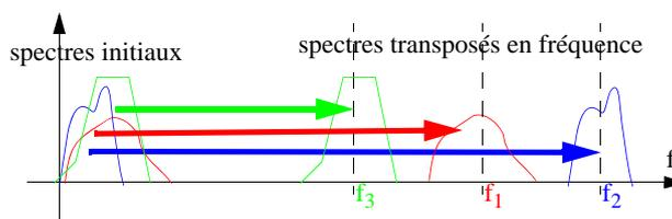
Lorsque la fonction de modulation existe la transmission est dite **analogique**. En fait de ce cas, on a une transformation d'une fonction continue en une autre fonction continue.
