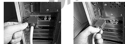
Serrer les deux molettes du connecteur.
