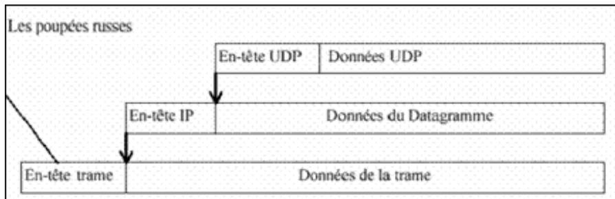
L'entête Ethernet sur un réseau Ethernet c'est la première encapsulation : couche 2.
