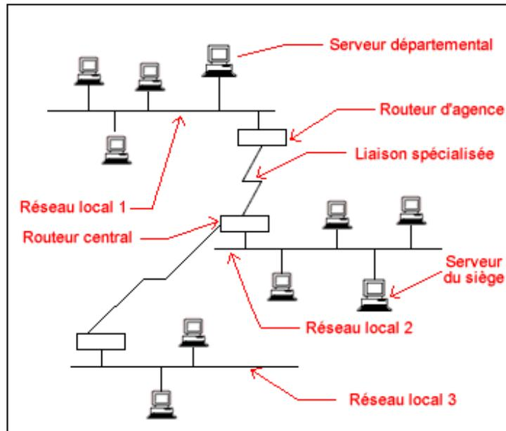
Les réseaux locaux permettent aux ordinateurs de communiquer entre eux sur un site (un bâtiment, une agence, un bureau). On utilise pour ces communications des technologies permettant aux ordinateurs de communiquer rapidement mais sur de courtes distances (100 mètres par exemple).
