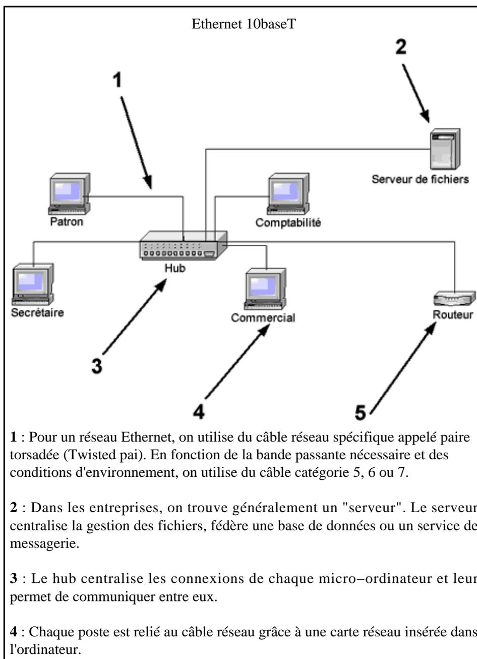
Ici le support est constitué de 2 paires de fils torsadés (twisted pairs), prolongés par des connecteurs d'extrémité appelés RJ45. Ces câbles vont dans des appareils appelés HUB qui connectent les machines.
