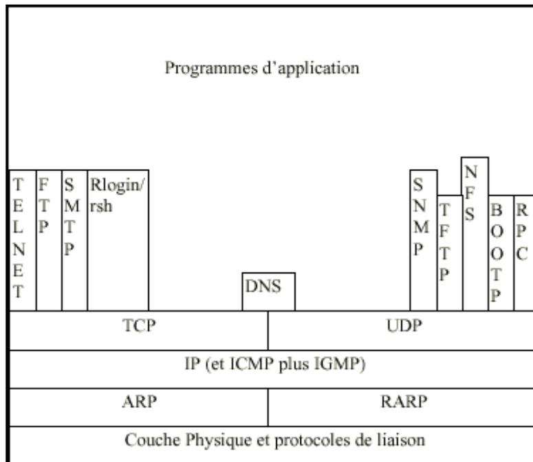
La couche IP dans la machine source ou destination agit comme une couche de multiplexage. C'est un peu comme une gare de triage.
