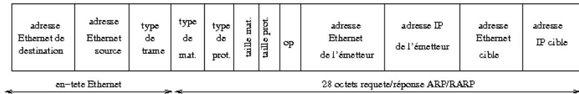
FIG. 14 – Requête ou réponse ARP sur un réseau Ethernet.
