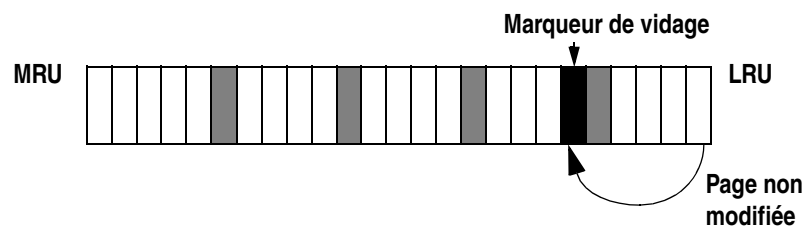
Figure 7-3 : La stratégie MRU place les pages juste avant le marqueur de vidage
