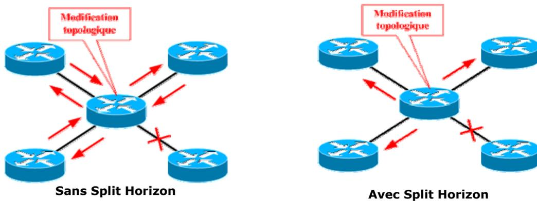
Le principe du Split Horizon est simple. Aucune information de mise à jour ne sera renvoyée par le chemin par lequel on a appris la modification de topologie. Ceci permet d'éviter de renvoyer à la source des informations erronées.
