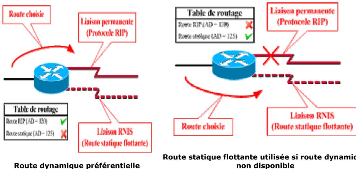
Cette route statique flottante n'apparaît dans la table de routage que lorsque l'entrée fournie par le protocole de routage n'est plus valide.
