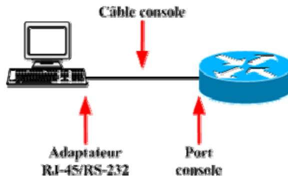
Il faut connecter le port console du routeur à un port série (RS-232) en utilisant un câble console.
