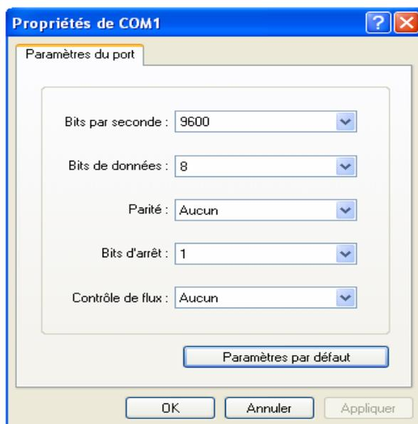
**Paramètres de connexion pour HyperTerminal**
