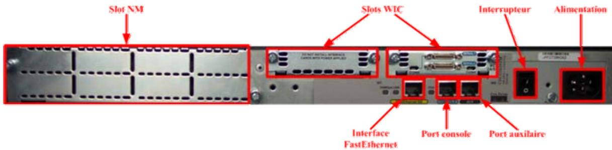
**Vue arrière d'un routeur Cisco 2620XM**
