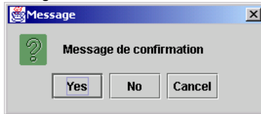
Exemple de fenêtre obtenue avec JOptionPane et l'option YES_NO_CANCEL_OPTION
