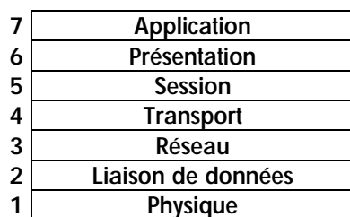
Fig. 1 - Modèle de référence OSI
