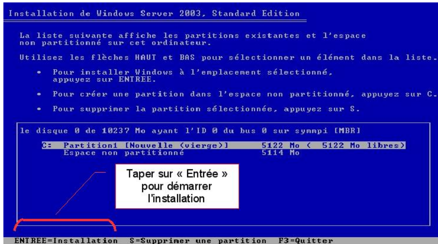
FIG. 5 – Installation sur la partition créée
