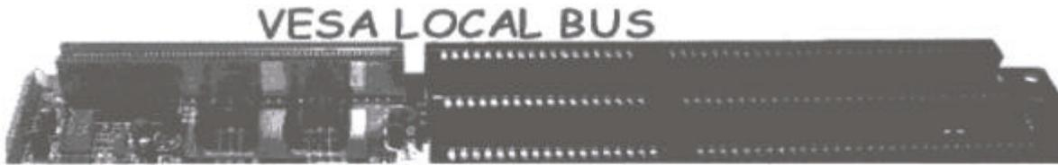
Ce standard appelé VESA ( Vidéo Electronics Standard Association d'affichage sur le bus local. On parlera de VESA local bus ( VLB ). Le nombre de connecteurs est limité à 3, sa largeur est de 32 bits et sa fréquence maximale est de 33 Mhz. Les connecteurs VESA se reconnaissent facilement à leur couleurs marron .
