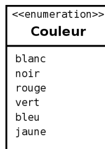
FIG. 4.9 – Définition d'une énumération en utilisant un classeur.
