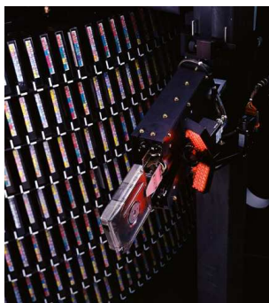
Figure 3: Bras du robot prenant une bande de sauvegarde
