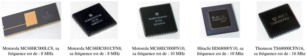
Figure n° 11 : Quelques formes de circuits 68000
