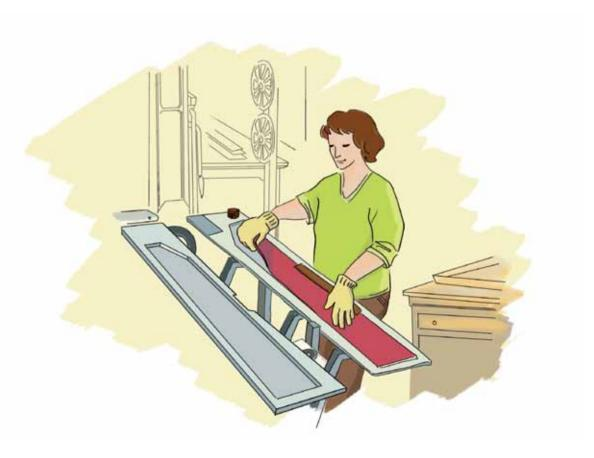
Fabriquer ou réparer des pièces composites. Fabriquer un moule et réaliser dans celui-ci des pièces composites par application de couches successives de fibres textiles imprégnées de résines
