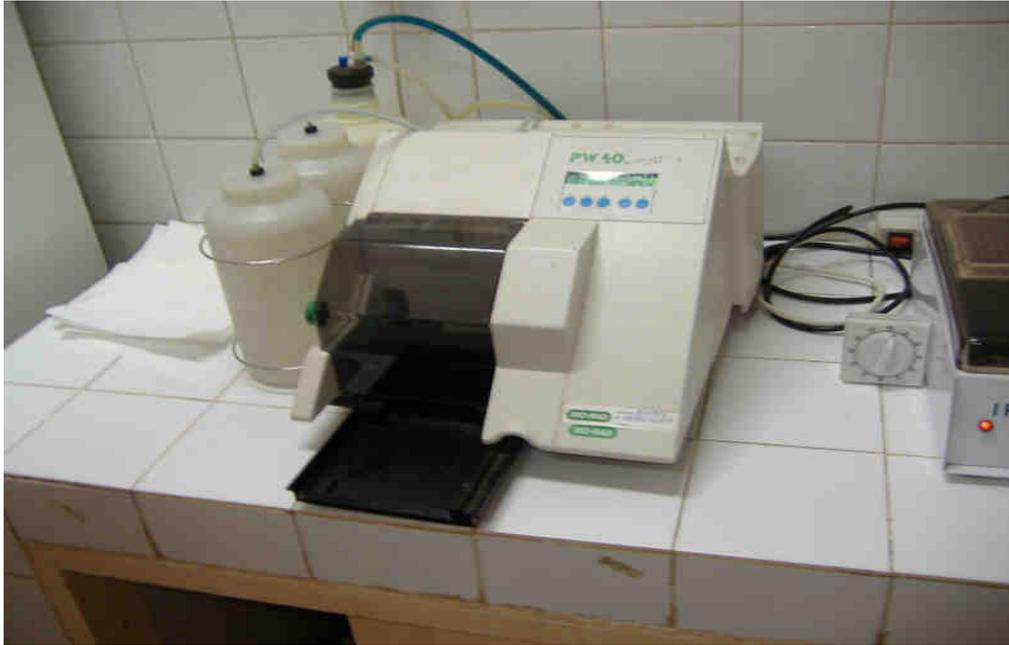
**fig 5 : Laveuse automatique des microplaques d'échantillons**
