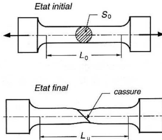
Si l'éprouvette est normalisée, on a  $L_0 = 5,65\sqrt{S_0}$ .
