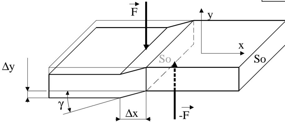
De même que pour l'extension, on peut établir, en cisaillement, une loi de proportionnalité entre la déformation et la contrainte :
