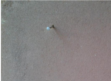
Photo 28 : Résistance au clou
