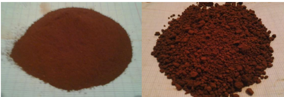
Photo 19 : Latérite tamisée (tamisât et refusât)
