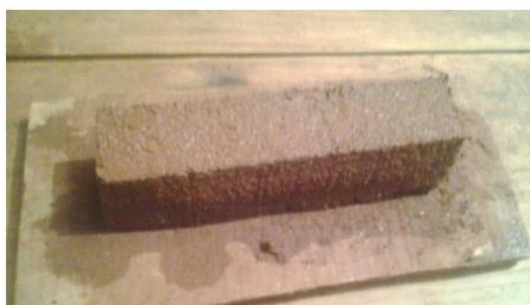
Photo 24 : Schéma d'une éprouvette 4x4x16 cm
