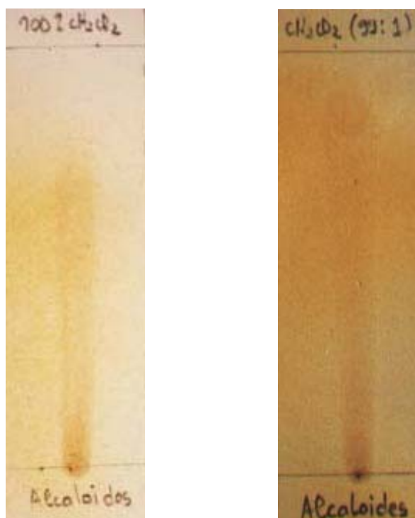
FIGURE N°15: CCM des alcaloïdes dans le système dichlorométhane, dichlorométhane -méthanol (99 :1) révélé au réactif de Dragendorff.
