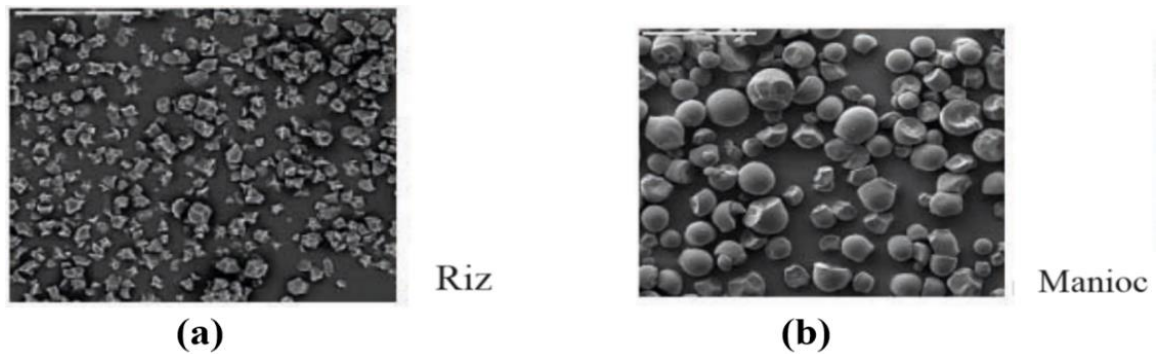
FIGURE 1 : Formes et tailles des granules d'amidon de riz (a)et de manioc (b), (MEB grossissement \times 280 ) d'après ATKIN (1999) .
