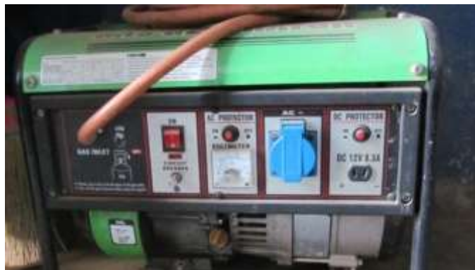
Figure 21 : un générateur électrique à biogaz (SAMVA Manjakaray)
