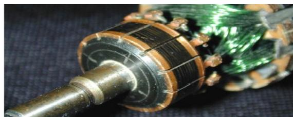
Figure 17 : Collecteur d'une machine à courant continu de faible puissance.
