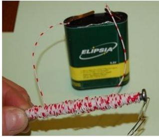
Figure 12:Un électroaimant avec une bobine artisanale.
