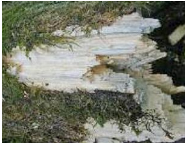
Photo 3 : Pourriture fibreuse Source : CLESSE, 2008
