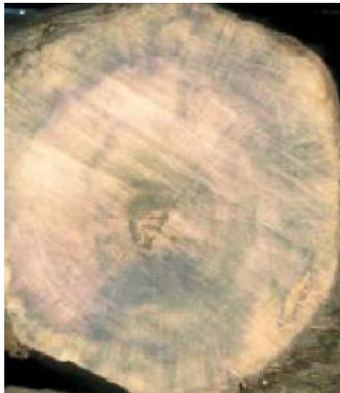
Photo 1 : Bleuissement sur grume de Virola, en Guyane Source : FOUQUET, 2003
