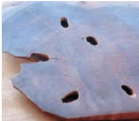
Photo 5 : Section de galerie de coléoptères Cérambycides sur du Manilkara, en Guyane
