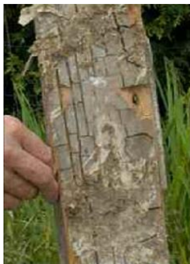
Photo 2 : Planche attaquée par la pourriture cubique Source : FRAITURE, 2008
