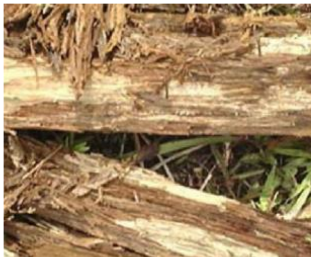
Photo 4 : Pourriture molle sur poteau enterré de Brosimum utile traité après 7 ans d'exposition Source : BEAUCHENE, 2006
